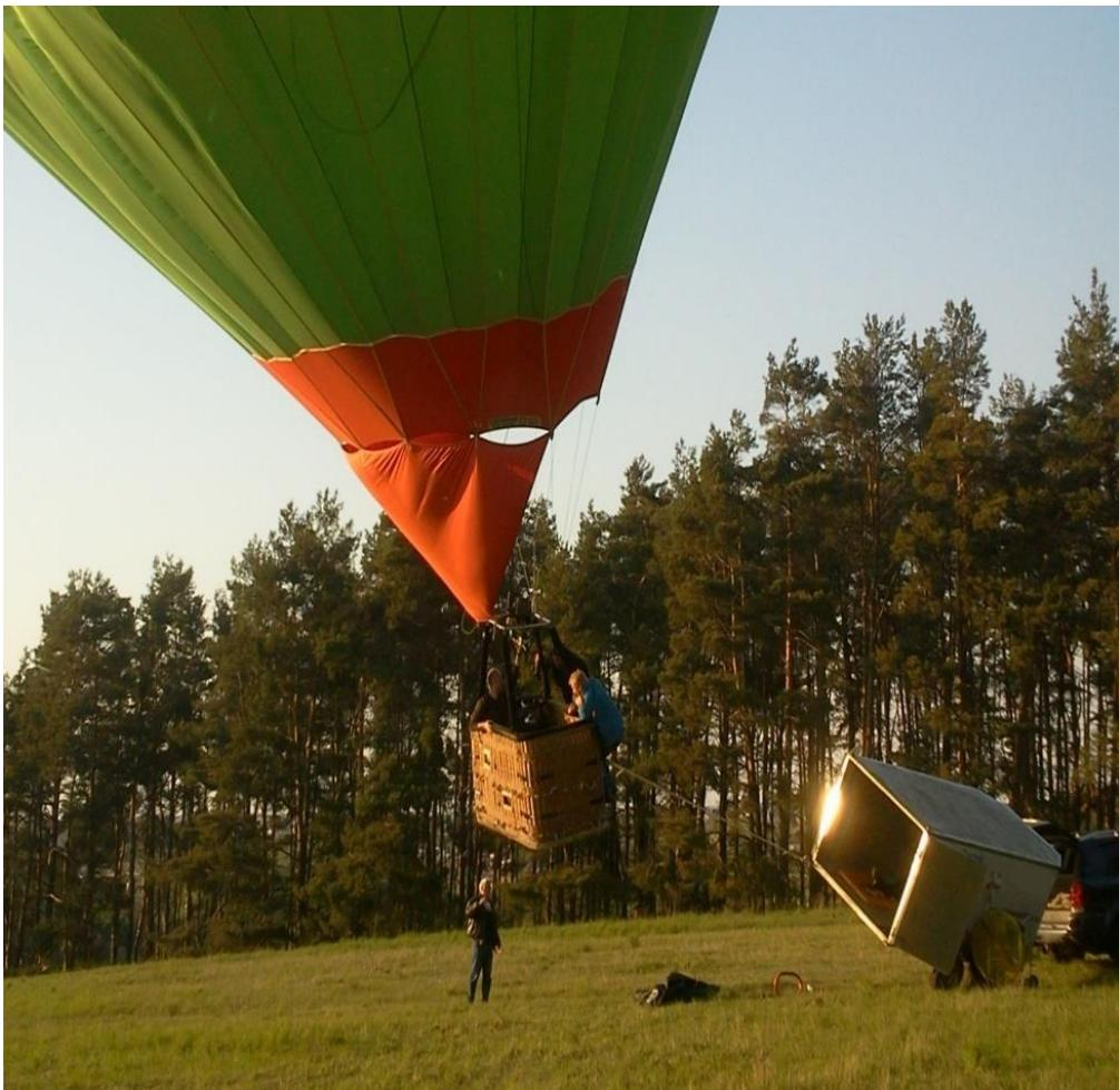
**Die Startfessel ist am Zugfahrzeug (!) (am Zugfahrzeug !) an geeigneter Stelle zu befestigen.**
